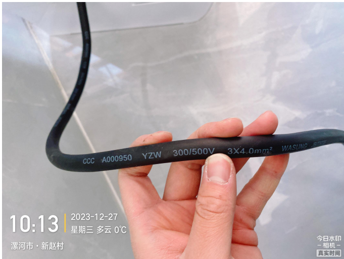
现场检验照片
