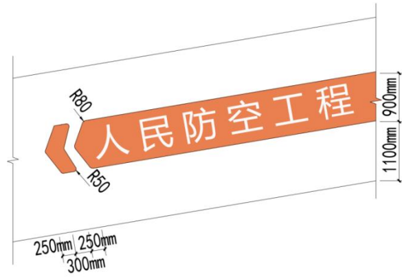
图 2 非机动车坡道侧墙标识样式示例
